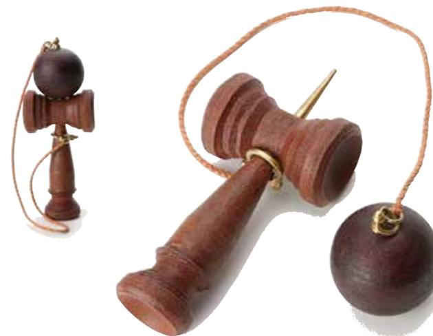
革をより身近にしたいという思いから、子どもも大人も楽しめるようにと作られた革製けん玉。牛革の床革を積み革にして制作。実際に使って遊べるよう真鍮の芯材を入れ、革にはシェラック樹脂を用いた含浸・硬化処理を2度加えている。素材選びや製造手法など研究を重ね、ひと目見ただけでは革とわからない独特な風合いを手に入れた。
