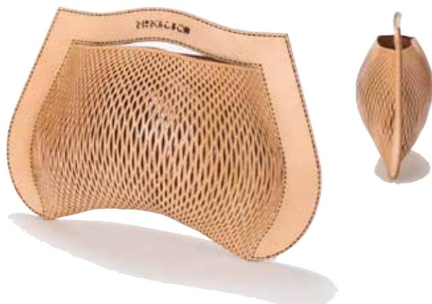
一枚の革を図面に従いレーザーカッターで切り抜き、制作したバッグ。縫製の穴も切り抜かれるので、初心者でも3時間程度で完成でき、デジタル化された図面により、遠隔地で全く同じものを作る。職人が編んだ籠細工のようなデザインは、非ユークリッド幾何学の考え方とパラメトリックデザインにより構成され、伝統と未来が交差している。
