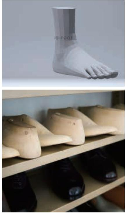
上／遠隔採寸できるシステム「iD-FOOT」。下／快適に履ける靴をつくるためには、木型制作が欠かせない
