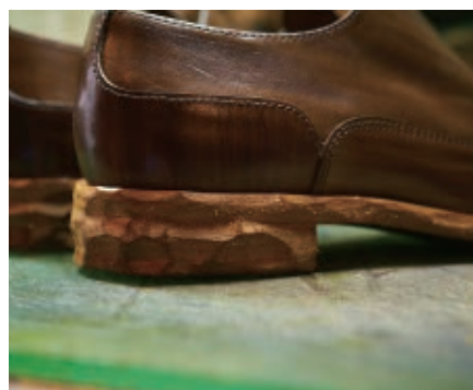
上／複数の茶系染料を筆に含ませ、木目調に仕上げる。 下／ソールの切削には、一般的なカッターを用いた
